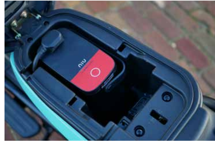
Onder het zadel tref je de 48V/21Ah accu
