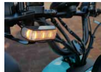
Ook de knippertichten zijn voorzien van LED
